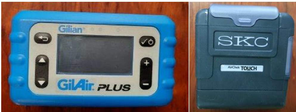
Bombas de muestreo utilizadas en la medición: GilAir Plus de Gilian y SKC AirCheck Touch
