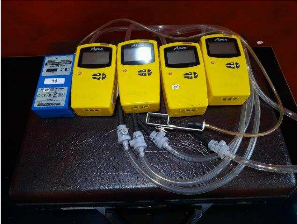
Bombas de muestreo utilizadas en la medición: LFS 113 de Gilian y Apex y Apex Pro, de Casella
