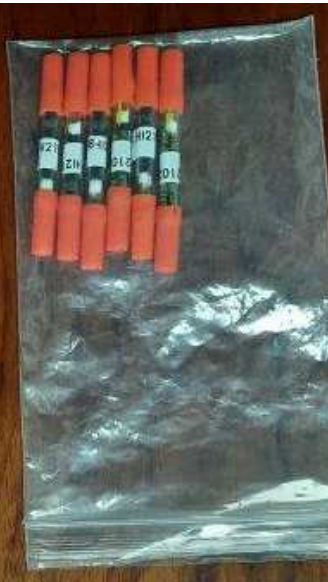
Captador pasivo para medición de formaldehído (arriba izquierda); bombas de muestreo con filtro y tubo adsorbente para determinación de hidrocarburos policíclicos (arriba derecha); tubos de muestreo para la captación de acroleína e hidrocarburos aromáticos (abajo izquierda); filtros de cuarzo para captación de partículas de combustión de pequeño tamaño-hollín (abajo derecha)
